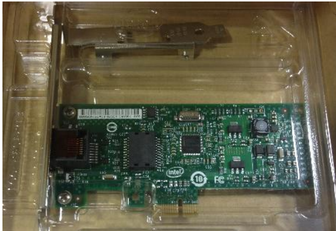
ネットワークカード (インテル Gigabit CT Desktop Adapter EXPI9301CT)
