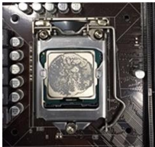
マザーボードにCPU を装着した状態
