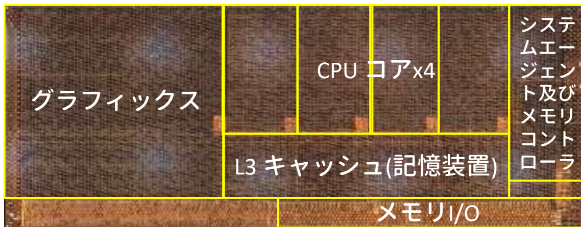
CPU(Ivy Bridge)のダイ構成
