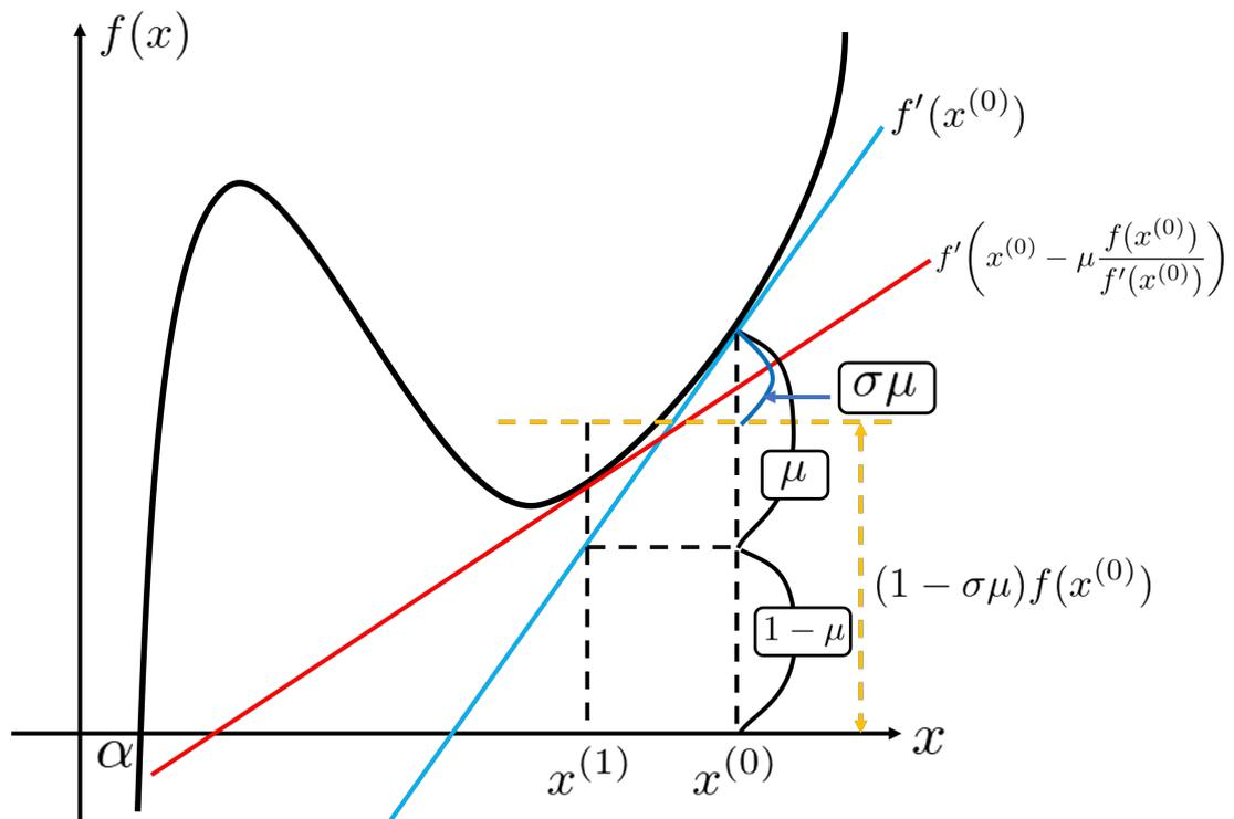
図3 減速ニュートン法の例.  $\alpha$  が求めたい解.  $f'(x^{(1)})$  が負にならないように  $f\left(x^{(0)} - \mu^{(0)} \frac{f(x^{(0)})}{f'(x^{(0)})}\right) < (1 - \sigma\mu^{(0)})f(x^{(0)})$  という制限をかけている. ここで四角で囲まれた文字は距離ではなく比率を表している.
